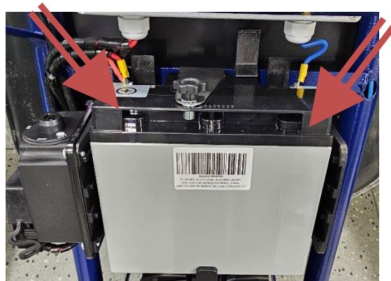
obr. 7. - odpojení akumulátoru z držáku obr. č. 8. - označení místa, kde se uvolnění šroubu. odšroubuje akumulátor od vodičů
